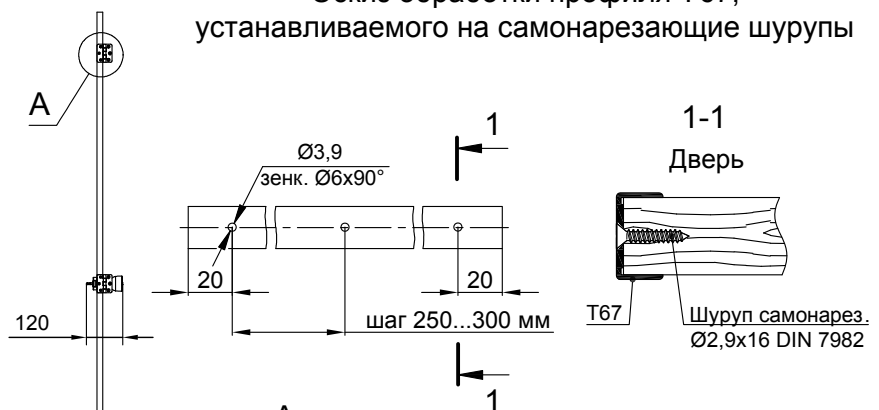
Эскиз обработки профиля Т67 под установку петли Т328
