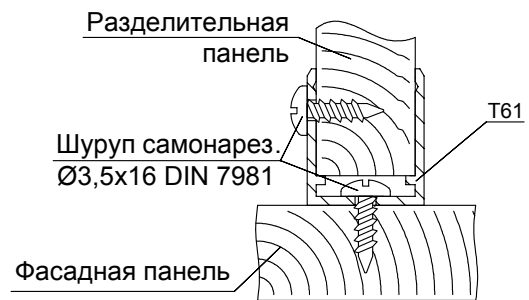
Соединение разделительной и фасадной панелей
